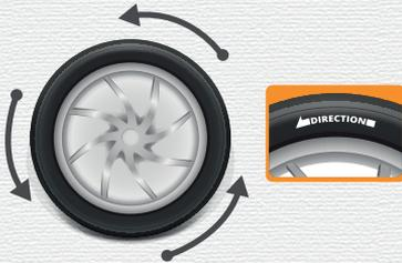
Algunos fabricantes imprimen sobre el lomo, o costado, de las llantas una marca (flecha) que indica el sentido de rotación de los mismos.
